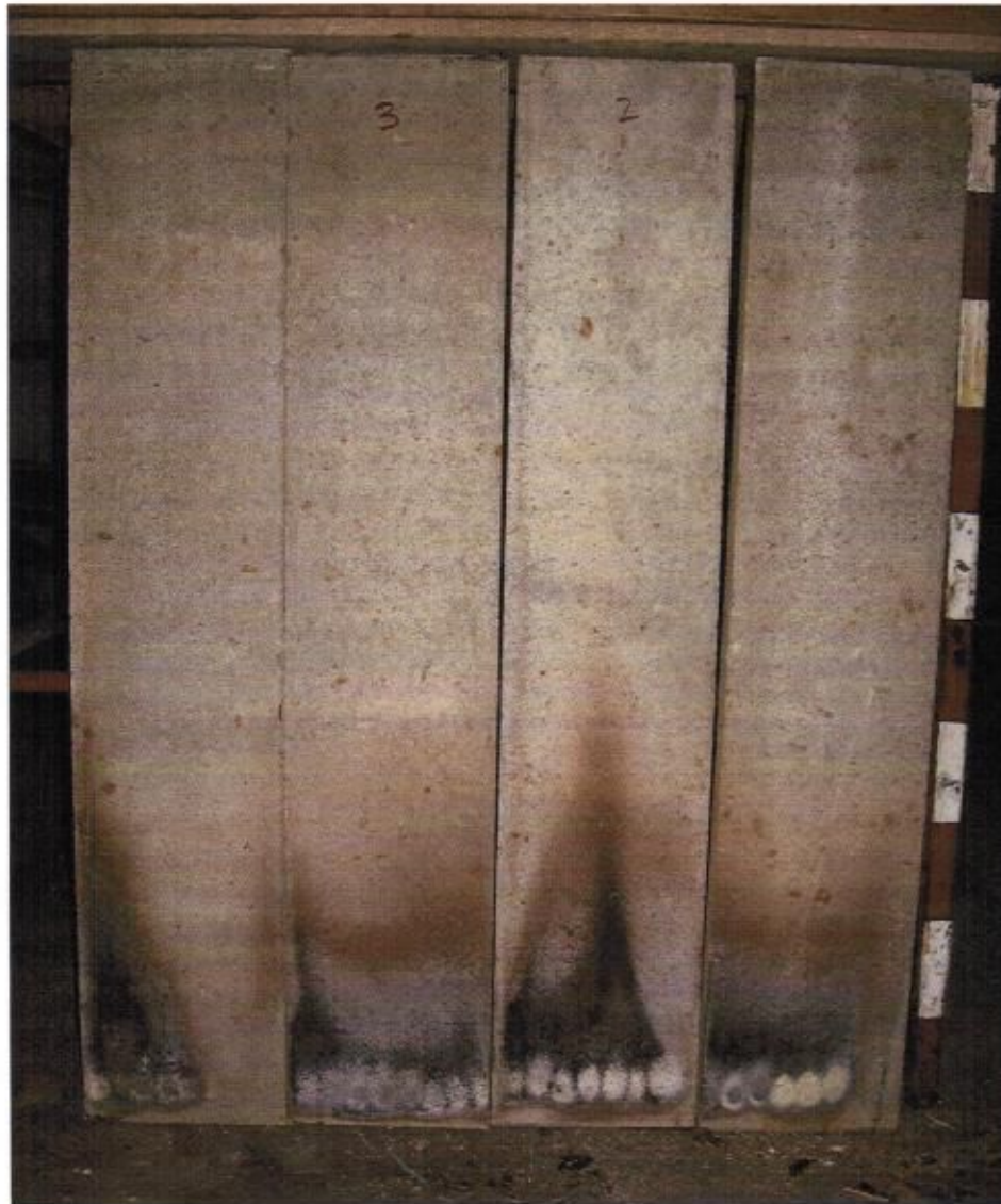
Внешний вид плит цементностружечных ЦСП после испытаний по ГОСТ 30244 метод II
